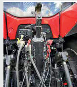
Zu eng: die Ölschlüsse am Oberlenker.
