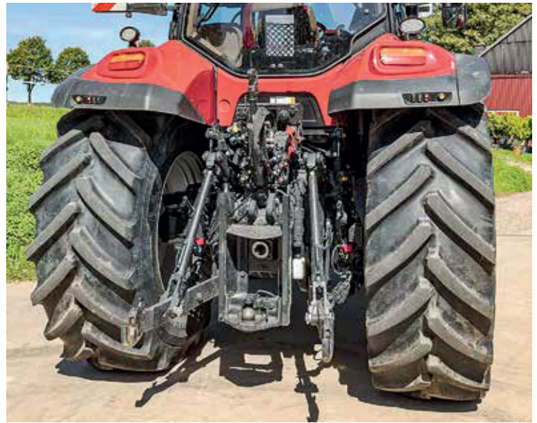
Hubkraft und Ölmenge sind gut, die Ordnung (Strom und Luft oben, Öl unten) passt auch. Hydraulische Seitenstabis sind prima, aber nicht nötig.
