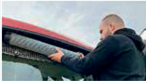
Einfach: Kabinenfilter ohne Werkzeug aus-/einzubauen.
